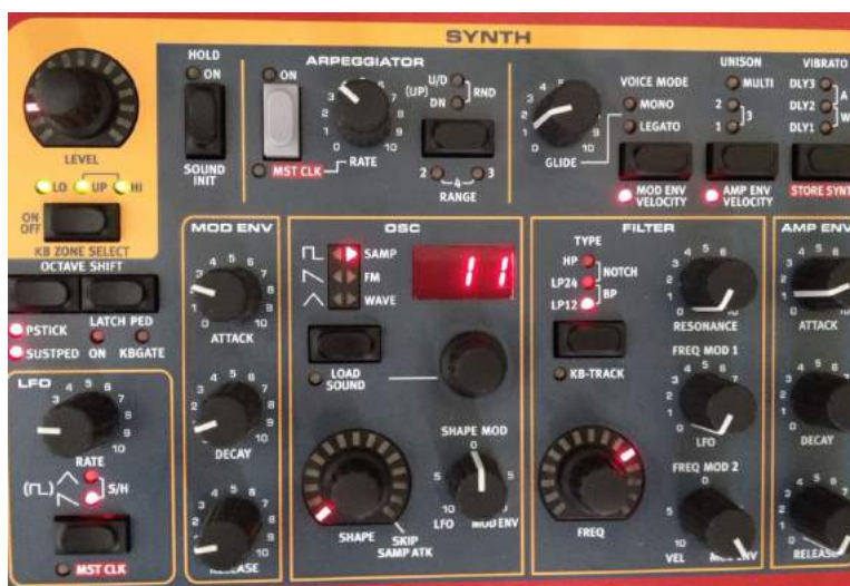
Figura 4a: frequency modulation com o OSC Shape variando entre (0.0 - 10.0) na seção synth do sintetizador Nord Stage 2 Ex. Fonte: próprio autor.
