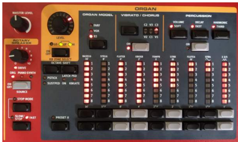
Figura 2a: B3 Gospelly com os ajustes de drawbars, chorus tipo 3 ativado e efeitos de percussion com envelope que controla o terceiro harmônico, o tempo de decay em fast e o volume no modo soft na seção organ do sintetizador Nord Stage 2 Ex. Fonte: próprio autor.
